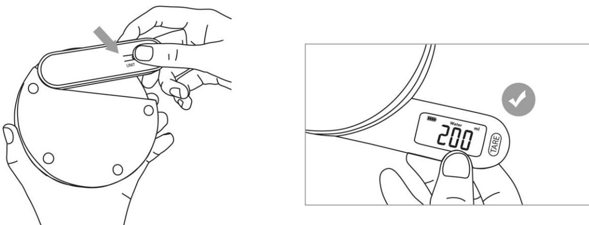
Drücken Sie die UNIT Taste (auf der Rückseite des Displays) um die Gewichtseinheiten zwischen g, oz, Water ml, Milk ml umzustellen.
