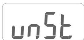
**Весы установлены нестабильно.** Если появляется код данной ошибки, это значит, что весы нестабильно установлены. Разместите их на твердой и ровной поверхности.
