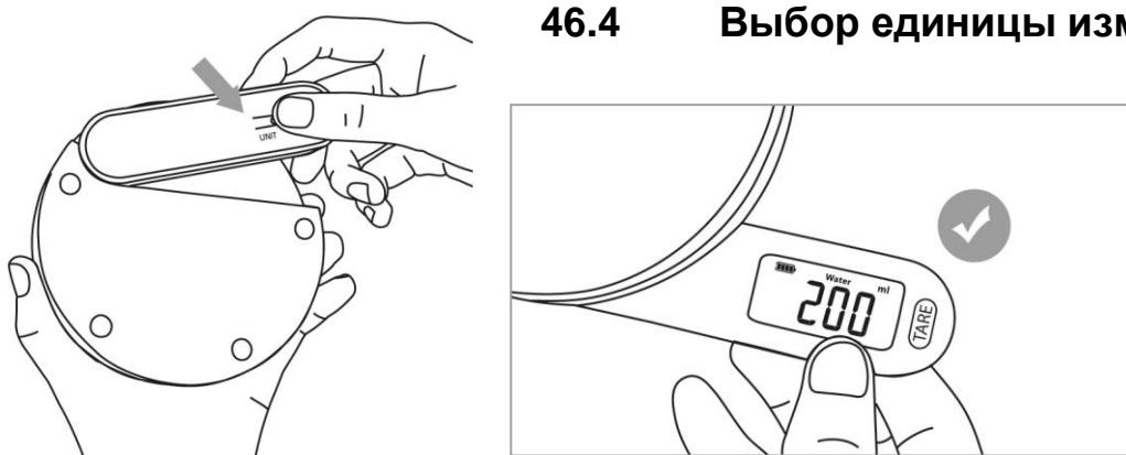
Нажмите на кнопку UNIT (расположена на задней стороне дисплея) для того, чтобы выбрать единицу измерения между граммами, унциями, миллилитрами воды или миллилитрами молока. Перед взвешиванием нажмите на кнопку UNIT. Вы не сможете нажать кнопку ТАРА (TARE) одновременно с кнопкой UNIT.
