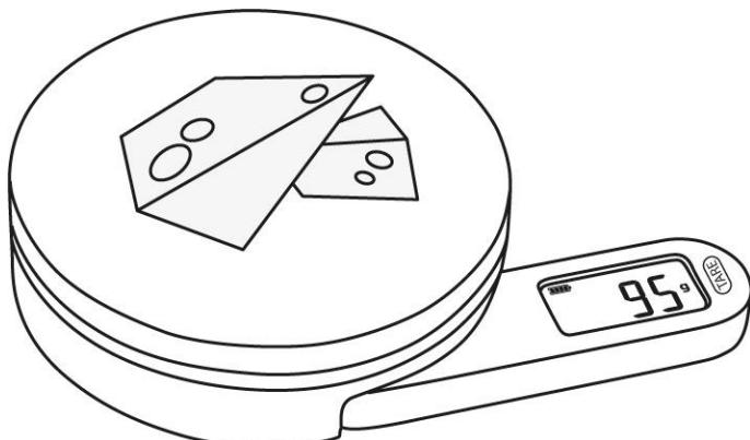
Поместите прибор на твердую и ровную поверхность. Поворачивайте рычаг по часовой стрелке до тех пор, пока на дисплее не появится ноль.
