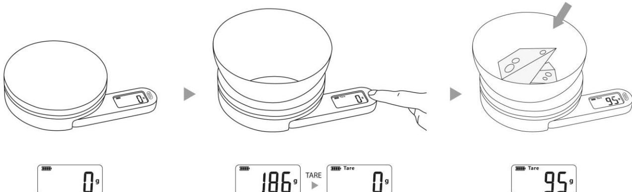
Поместите на весы пустую тару. На дисплее отобразится ее вес. Нажмите кнопку ТАРА (TARE) и на дисплее отобразится ноль, а вес тары пропадет.
