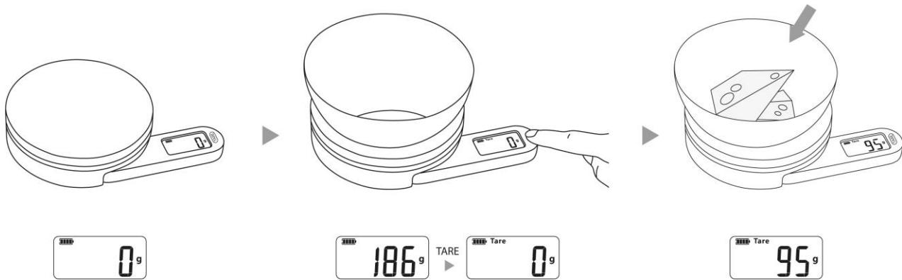
Posizionare un contenitore qualsiasi sul piatto di pesatura. Sul display viene visualizzato il peso del contenitore.
