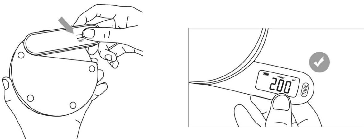
Pulse la tecla UNIT (en la parte posterior del display) para conmutar entre las unidades de peso g, oz, ml agua, ml leche.
