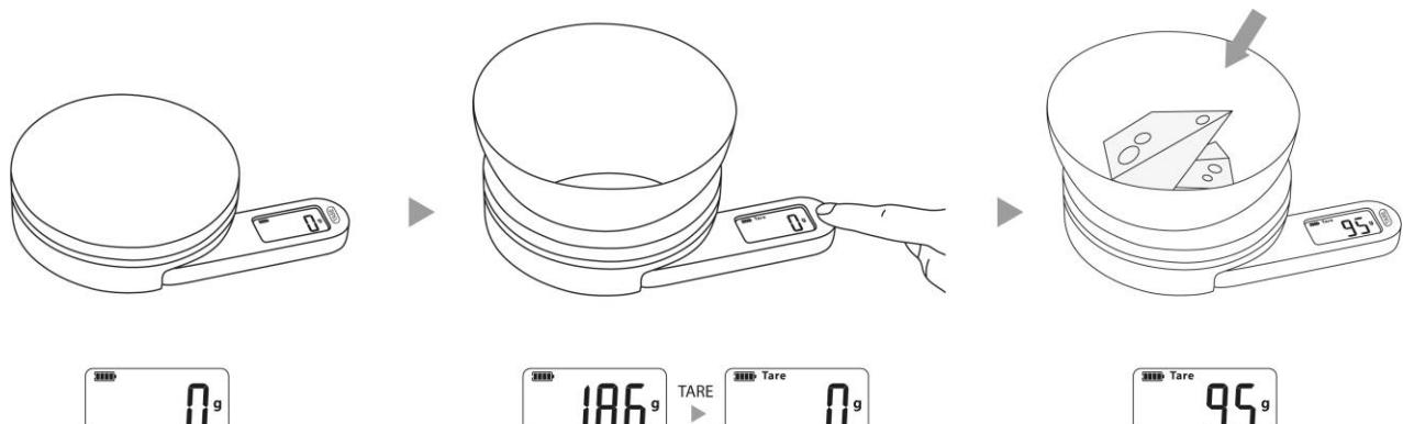
Colocar un recipiente en la bandeja de pesaje, la pantalla muestra el peso del contenedor. Pulse TARE, la pantalla a cero.
