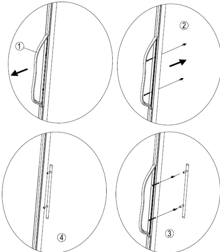
Bitte beachten Sie, dass Sie den mitgelieferten Edelstahlgriff vor dem ersten Gebrauch an die Tür des Gerätes anschrauben müssen. Dazu schieben Sie das Dichtungsgummie an der Rückseite der Tür zur Seite, um die vorgebohrten Löcher freizulegen. Mithilfe der beiliegenden Schrauben können Sie den Griff an der Tür montieren.
