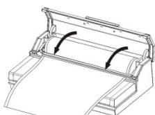
Überprüfen Sie, dass der Cutter an einem Ende der Cutterschiene positioniert ist. Drücken Sie dann die Cutterschiene wieder nach hinten.
