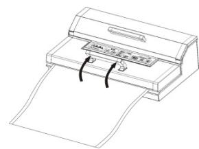
Drücken Sie den vorderen Griff wieder nach oben, öffnen Sie den Deckel und entnehmen Sie den Beutel.
