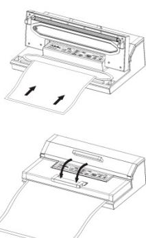
Reinigen und glätten Sie das offene Ende des Beutels und vergewissern Sie sich, dass keine Falten und keine Wellen auf den Flächen des offenen Endes sind.
