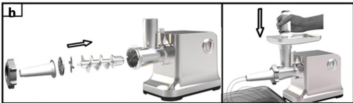
h) Sie benötigen den Aufsatz zur Wurstherstellung (13). Platzieren Sie die Schnecke (8) wie gewohnt mit dem dickeren Ende zuerst in das Schneckengehäuse (7). Setzen Sie Messer (9) und Lochscheibe (10, 11 oder 15) auf die Schnecke. Platzieren Sie dann den Aufsatz für die Wurstherstellung (13) auf Messer (9) und Lochscheibe (10, 11 oder 15). Drehen Sie den Fixierungsring (12) fest.
