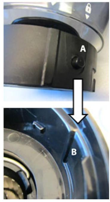
Zum Auseinanderbauen die Taste zur Entriegelung des Bohnenbehälters drücken und den Bohnenbehälter gegen den Uhrzeigersinn drehen, um diesen aus der Aufnahme zu lösen.
