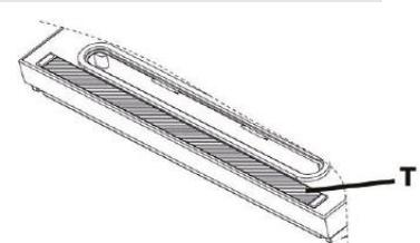
**9 herausnehmbare Vakuum-Kammer:** Verhindert, dass Luft aus dem Beutel austritt und entfernt überschüssige Flüssigkeit. Das offene Ende des Beutels muss innerhalb der Kammer positioniert werden. Die Kammer kann leicht herausgenommen und gewaschen werden.
