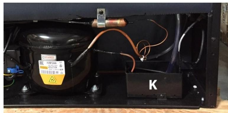
Entfernen Sie gegebenenfalls mit einem Schwamm das Kondenswasser aus dem Kondenswasser-Auffangbehälter. Dieser befindet sich auf der Rückseite des Gerätes unten rechts. Metallabdeckung bitte dafür entfernen und anschließend wieder festschrauben.
