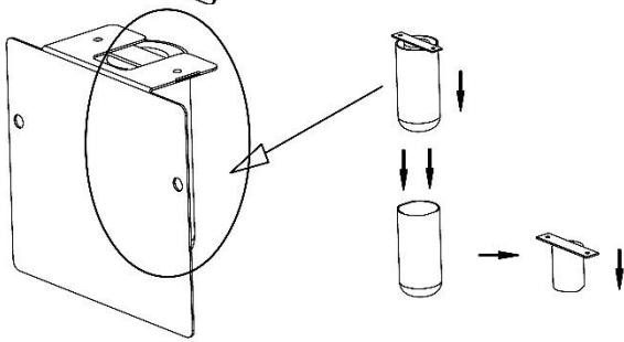
Hülle der UV-Lampe nach unten entfernen und Lampe austauschen.
