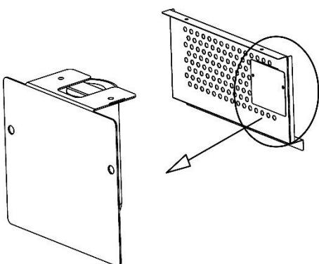
Afdekking verwijderen. De UV-lamp is hieraan bevestigd.
