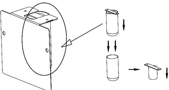
Retirez le couvercle de la lampe UV et remplacez la lampe.
