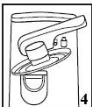
Qand la boîte est complètement ouverte, la découpe s'arrête automatiquement. La boîte reste dans la position, jusqu'à ce que le levier est relevé.
