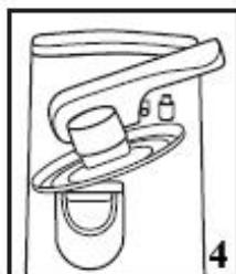
Wenn die Dose vollständig geöffnet ist, stoppt der Schneidvorgang automatisch. Die Dose verbleibt in ihrer Position, bis der Hebel angehoben
