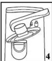
Druk de openingshendel vast naar beneden en houd deze vast, totdat het deksel van het blik automatisch doorboord is en het snijden begint zoals in afbeelding 3.
