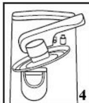
Cuando la lata está totalmente abierta, el proceso de corte se detiene automáticamente. La lata permanece en su posición hasta que la palanca se levante. Para soltar, sostener la lata con una mano y levantar la palanca con la otra mano. El sujetatapas magnético mantiene fija la tapa como se muestra en la ilustración 4.
